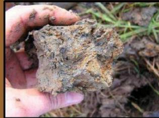
des taches de rouille dans les 25 premiers cm du sol et confirmées en profondeur (ou du gley gris-bleu...)
